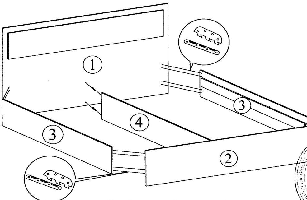
Для обеспечения более жесткой конструкции рекомендуем закрепить проложки из ЛДСП к царгам при помощи евровинтов, для этого в царгах на внутренних сторонах сделаны намётки.
