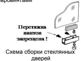
В отверстия Ø 8 мм. в стенке горизонтальной поз.8 и в стенке горизонтальной нижней поз.2 забейте втулки от стеклодержателей.
