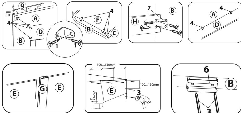
После успешной сборки каркаса комода, устанавливаем спинку «Е» (состоит из 2-х частей и профиля «G»). Далее устанавливаем подпятники №6.
